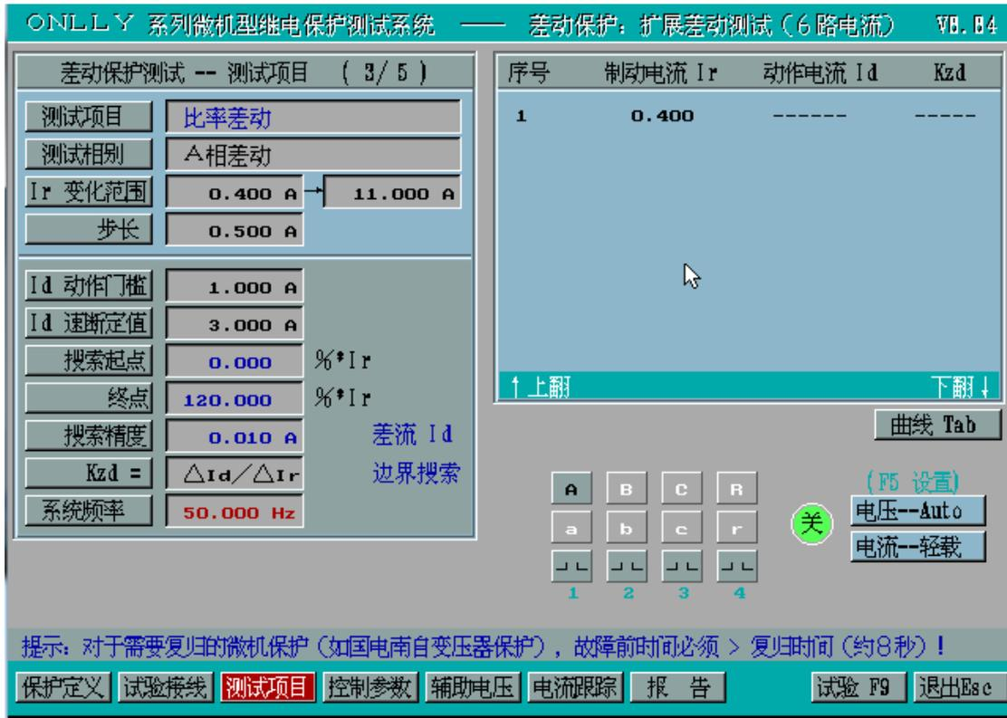
注：在发电机机端侧加AB相电压，使负序电压远大于负序电压整定值（5V）。原因是：当采用循环闭锁出口方式时，为提高发电机内部及外部不同相同时接地故障（即两相接地短路）时保护动作的可靠性，采用负序电压解除循环闭锁（即改成单相出口方式）。
